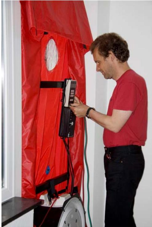
**Die neue EnEV schreibt für Luftdurchlässigkeitsmessungen Verfahren B der DIN EN 13829 vor.** Entgegen eines noch immer weit verbreiteten Irrglaubens steht „B“ allerdings nicht für „in der Bauphase“, sondern bezieht sich auf das Vorgehen bei der Gebäudepräparation.
