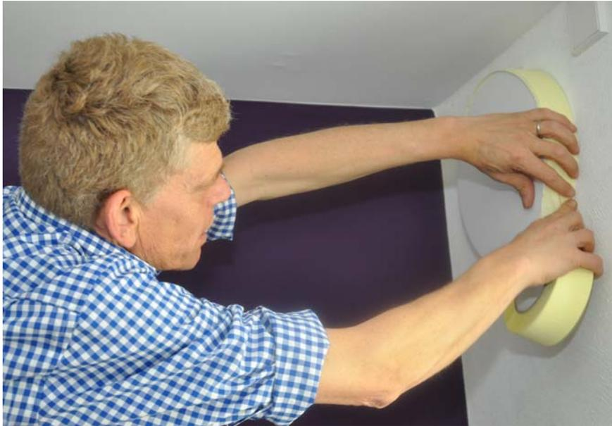
Luftdurchlässe von ventilatorgestützten Lüftungssystemen werden für den Dichtigkeitstest abgedichtet, wenn sie beim EnEV-Nachweis rechnerisch berücksichtigt wurden.
