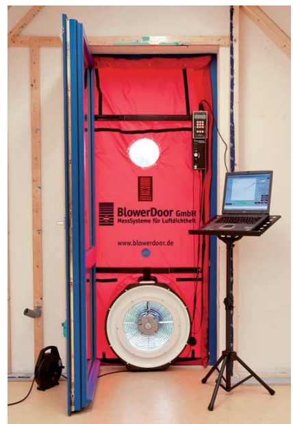
Bild 3.2: Foto einer eingebauten Blower-Door. [Foto: BlowerDoor GmbH]
