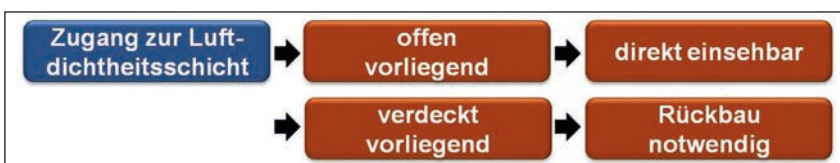
Bild 2.4: Zugang zur planmäßig vorgesehenen Luftdichtheitschicht
