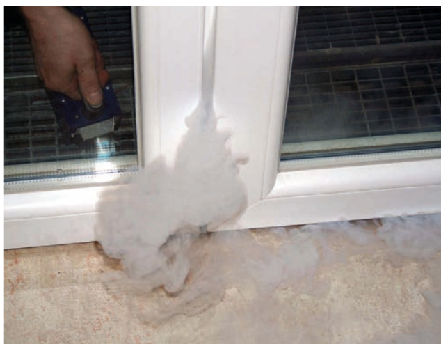
Bild 8.2: Sichtbarmachung von Leckagen durch Rauchdurchtritt zur Raumseite am Stulp einer 2-flg. Fenstertür bei natürlicher Druckdifferenz
